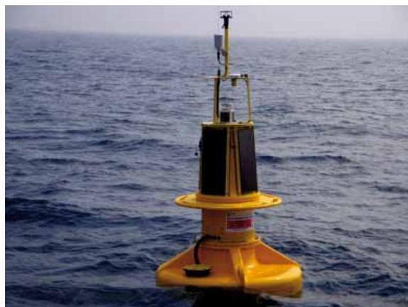
Figura 15. Boa *Watchkeeper* della Rete Ondametrica Nazionale.
