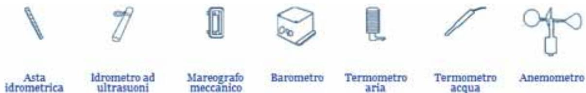
Figura 13. Strumenti di misurazione della rete mareografica nazionale (fonte: www.idromare.it)
