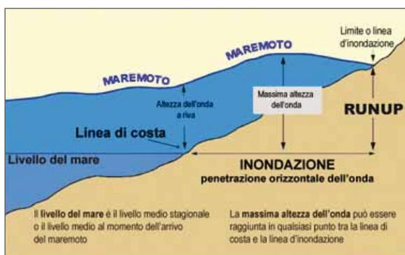
Figura 1. Schema della penetrazione a terra del maremoto
