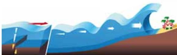
Figura 3. Generazione e propagazione delle onde di maremoto
