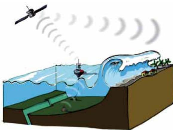
Figura 17. I sistemi di allarme attualmente in uso nell'Oceano Pacifico e nell'oceano Indiano per avvisare del formarsi di un maremoto sono basati su sensori collocati sul fondale marino che misurano le variazioni della colonna d'acqua e inviano l'allarme, attraverso boe galleggianti e satelliti, alle stazioni costiere.
